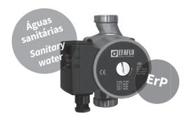
A série de circuladores CS é constituída por motores de imanes permanentes com 3 velocidades de rotação, com possibilidade de seleção manual de velocidade pretendida. Estes circuladores são utilizados para aplicações com águas sanitárias residenciais. A versão CS tem ligação por rosca.
