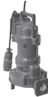
A gama de bombas submersíveis **TR**, com triturador, são de fabrico robusto e compacto, em ferro fundido, concebidas para trabalhar em regime contínuo (classe S1). Aptas a bombear efluentes sem fibras, evitar fibras textéis ou nylon. Permitem a passagem de sólidos em suspensão até 7 mm. São recomendadas para instalações com longas tubagens de descarga e de diâmetro reduzido. Podem ser instalados nas execuções móveis ou fixas, com pé de acoplamento. São fornecidas com cabo elétrico de 10 metros.
